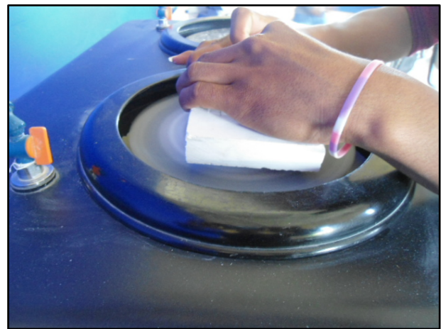
Figura 5. Fotografía del pulido de una probeta.
