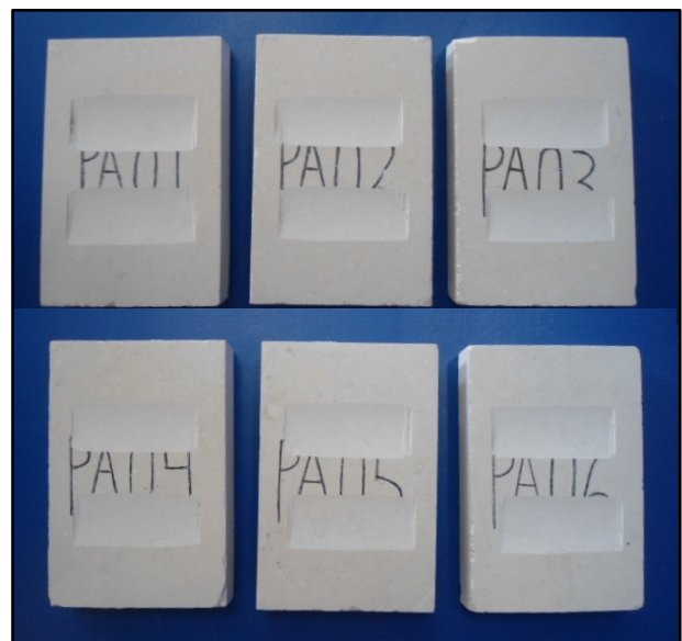
Figura 10. Fotografía de las probetas después del ensayo de abrasión.
